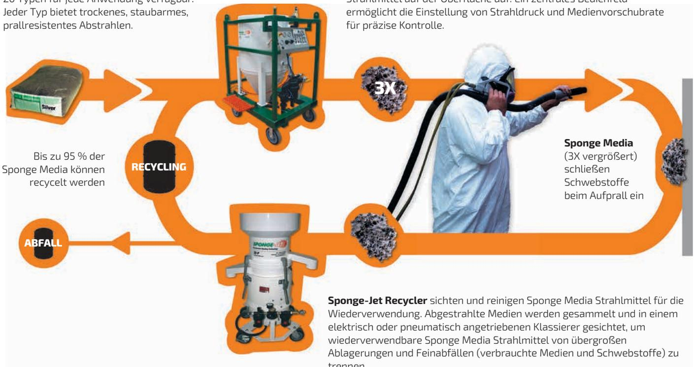
**Sponge-Jet Recycler** sichten und reinigen Sponge Media Strahlmittel für die Wiederverwendung. Abgestrahlte Medien werden gesammelt und in einem elektrisch oder pneumatisch angetriebenen Klassierer gesichtet, um wiederverwendbare Sponge Media Strahlmittel von übergroßen Ablagerungen und Feinabfällen (verbrauchte Medien und Schwebstoffe) zu trennen.
